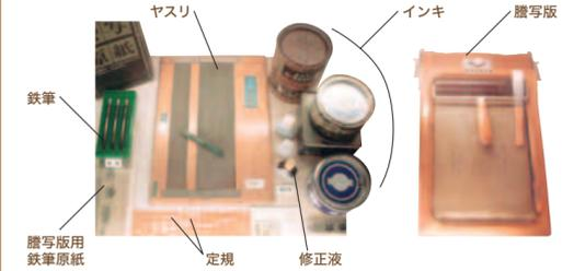
①原紙をヤスリの上に置き、鉄筆で文字や絵をかき、原版をつくる。②謄写版の刷り枠に原紙を固定する。③ハガキや用紙を挟み込む。④ローラーにインクをなじませ原紙の上を転がす。鉄筆で書いた部分からインクが染みて紙に印刷される。
